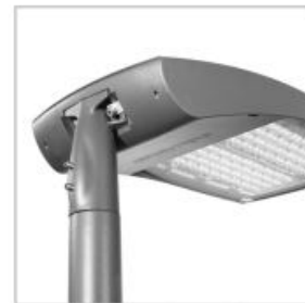
La gama TECEO GEN2 dispone de fijaciones universales para espigas entre Ø32 y Ø76 mm. También está disponible con una espiga penetrante específica de Ø60 mm.
