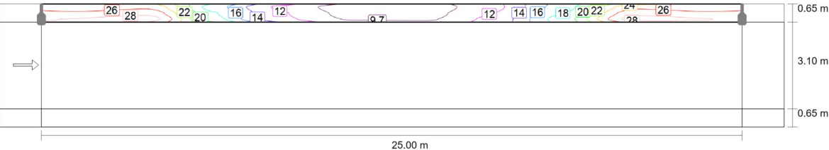
Valor de mantenimiento iluminancia horizontal [lx] (Líneas Isolux)
