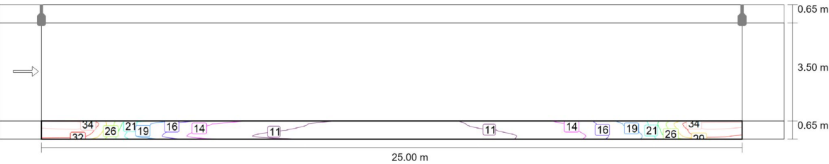
Valor de mantenimiento iluminancia horizontal [lx] (Líneas Isolux)
