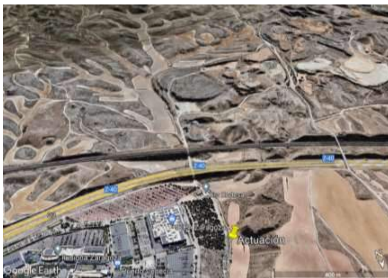
Figura 6. Disposición de las vales de fondo plano concentradas hacia un único barranco de drenaje, donde se ubica el paso bajo la autopista, lugar donde se concentraron las aguas de la cuenca de recepción y que luego drenaron en el camino.
