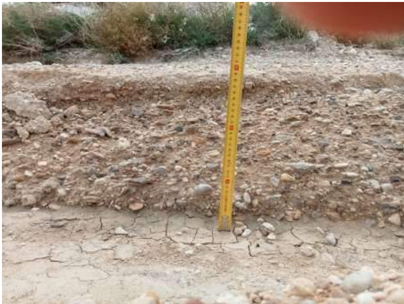
Figura 5. Depósito de val de fondo plano propio del área en que se emplaza el camino. El depósito ha sido erosionado por la acción del agua
