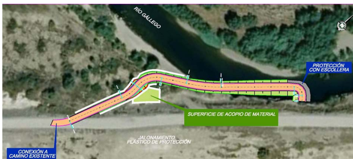
Ortofoto en la que se representa el camino de acceso y la superficie de acopio de material
