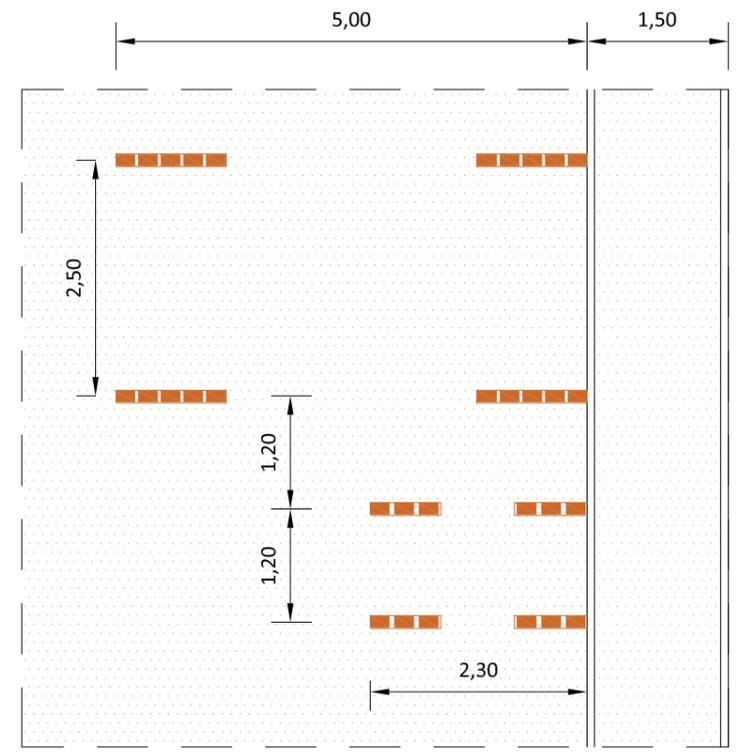
\*La dirección facultativa podrá decidir la colocación parcial de adoquines, limitandola al principio y final de la alineación según este esquema
