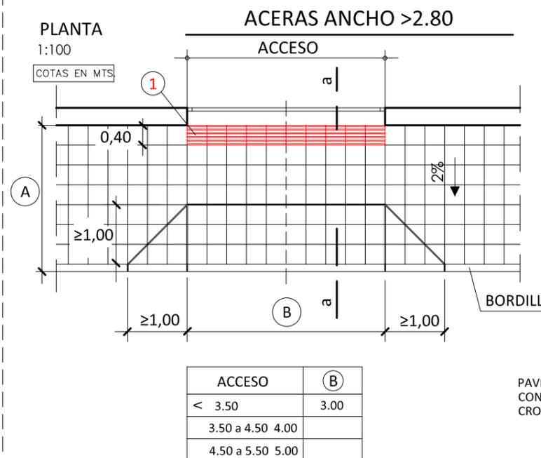
1 DETALLE BALDOSA ESPECIAL TACTIL DIRECCIONAL S/E
