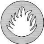
RIESGO DE INCENDIO
