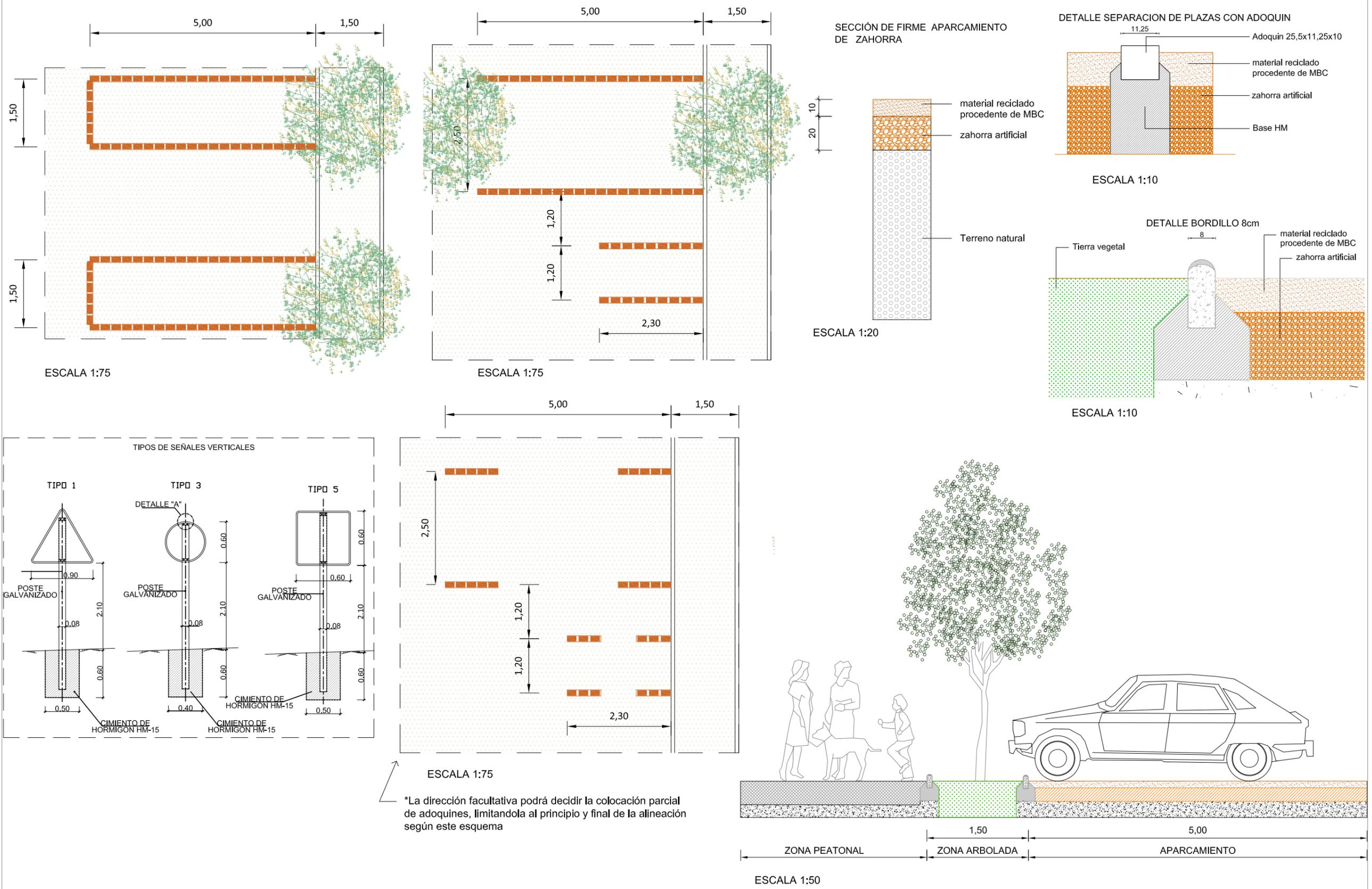
\*La dirección facultativa podrá decidir la colocación parcial de adoquines, limitandola al principio y final de la alineación según este esquema
