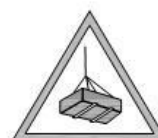
RIESGO CARGAS SUSPENDIDAS
