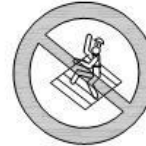
PROHIBIDO PISAR SUELO NO SEGURO
