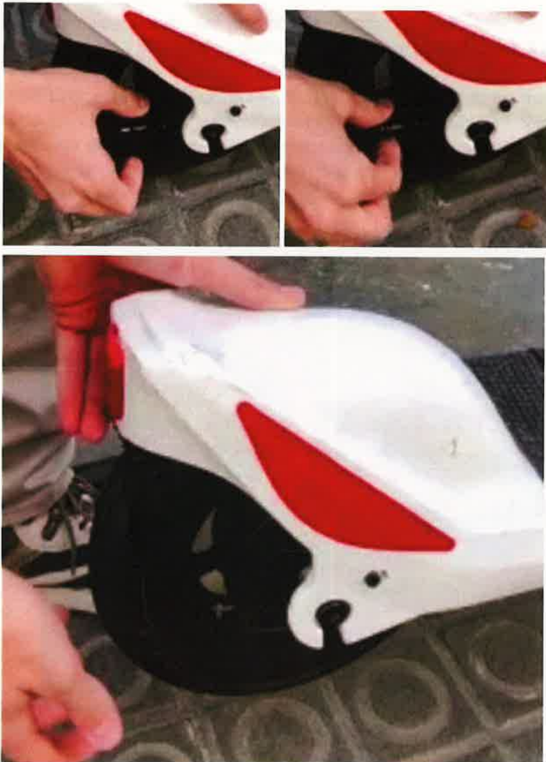
Antes, durante y después de aflojar el cable que acciona el freno tambor
