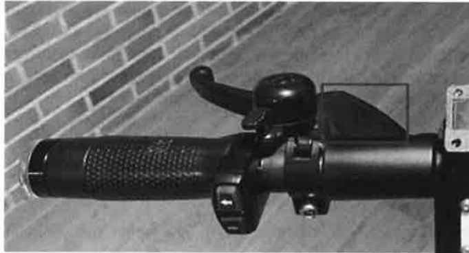
Imagen 1 - Actuador de los sistemas de freno con protección anti-vandálica
