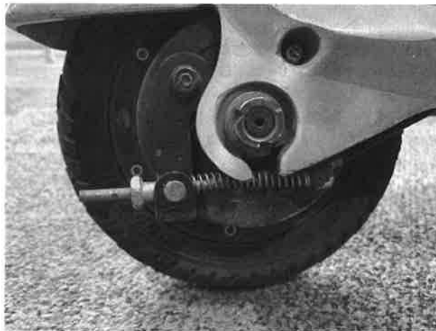
Imagen 7 - Sistema de frenado mecánico con tambor
