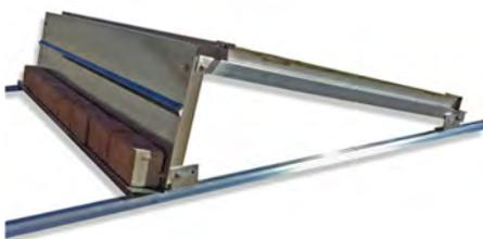
**Estructuras fijas de aluminio** dirigidas a cubrir las necesidades de grandes instalaciones sobre cubierta, con una solución idónea para diferentes tipos de superficies como: hormigón, bitumen, PVC, grava incluso chapa trapezoidal en las que se puede fijar la estructura directamente a la superficie o sobre lastres cuando la cubierta no se puede perforar y admite poco peso.
