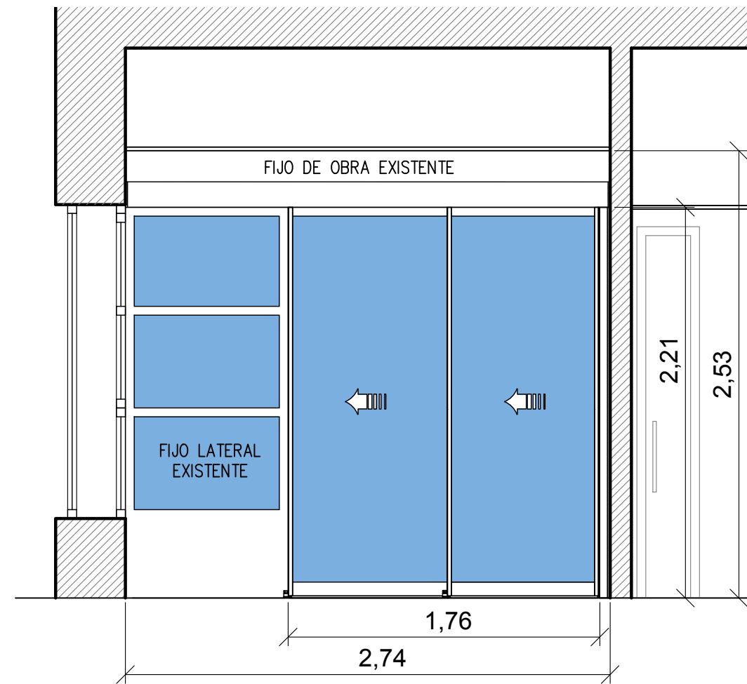
VISTA B - B' (VER DETALLE CONSTRUCTIVO Nº 1) E=1:30
