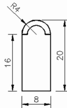
En todos los casos, los bordillos serán rectos o con la curvatura adaptada a su ubicación. La capa superficial (doble capa) será de espesor no inferior a uno con cincuenta centímetros (1,50 cm).
