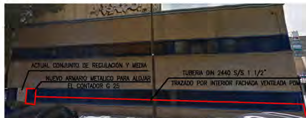
DETALLE N°1: TRAZADO DE LA TUBERIA POR EL PDM "CIUDAD DE ZARAGOZA"
