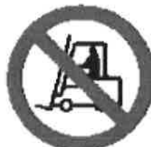
Prohibido a los vehículos de manutención
