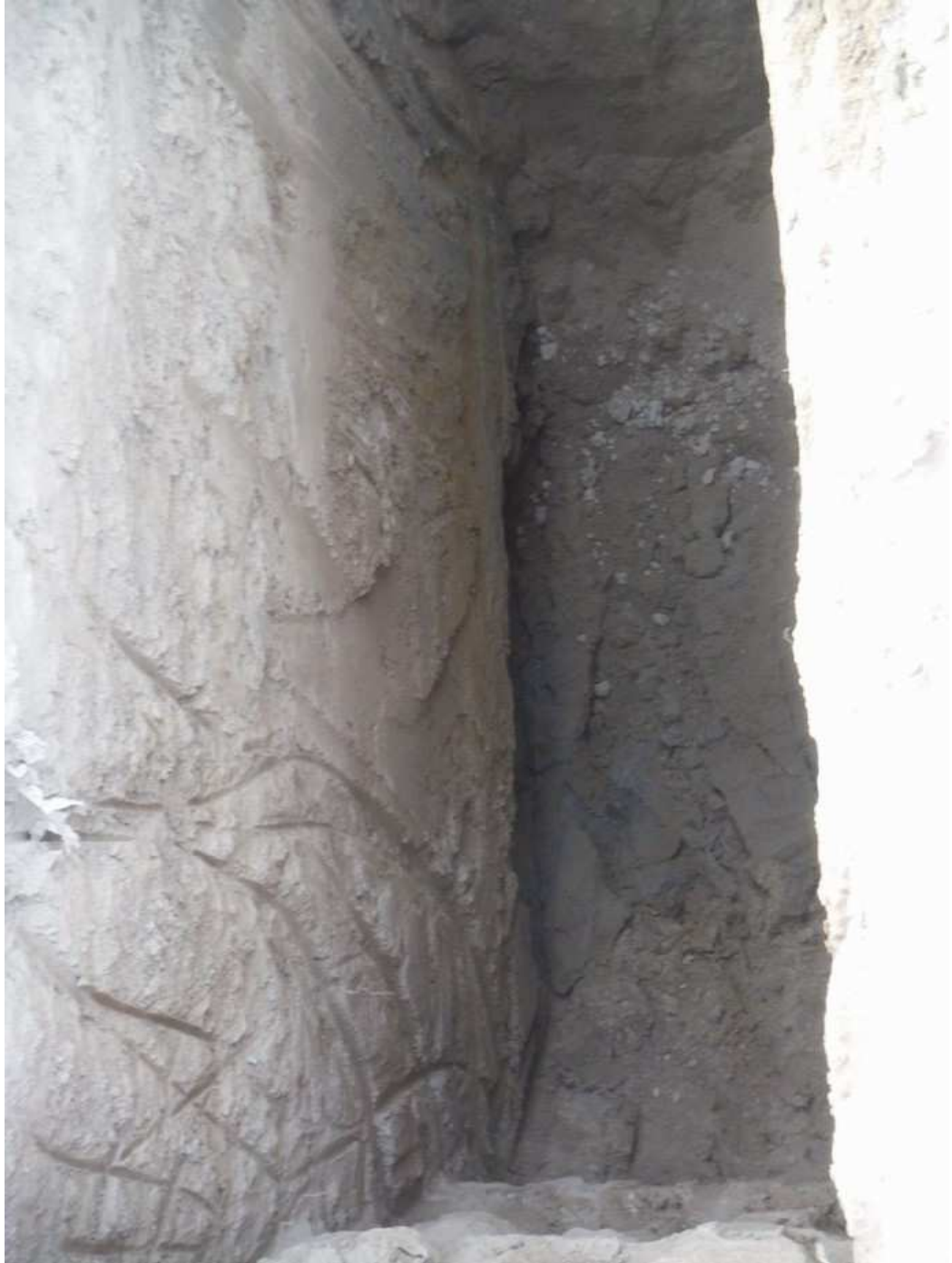
Foto nº 6: Calicata nº 2, Arenas finas a medias marrones con pasadas de limos algo arcillosos grisáceas. A 1,7 m aparecen muy húmedas y a 2,5 m saturadas (nivel freático).
