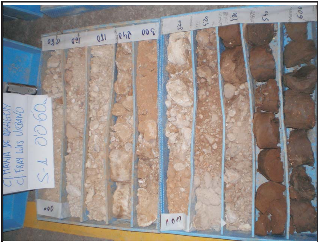
FOTO N°1-Sondeo n°1. Cajas n° 1y 2 . Profundidad: 0.0 a 6.0 m
