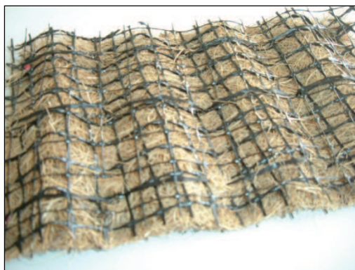
Foto 2. Detalle del tipo de geomalla a utilizar.
