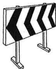
VALLA DE DESVIAMIENTO DE TRAFICO
