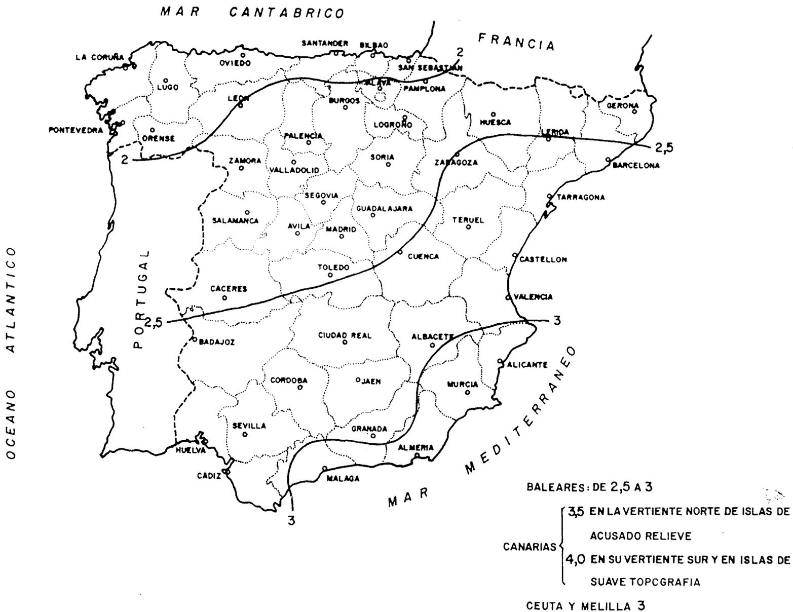
Figura A.7.3. : Mapa del coeficiente corrector del umbral de escorrentía.
