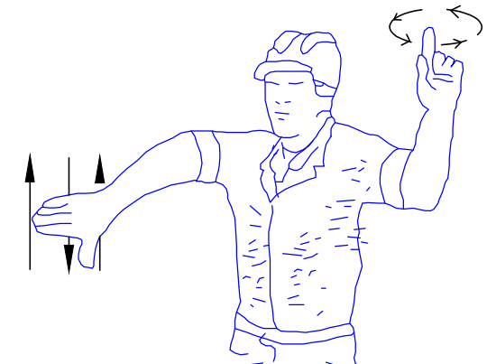
10 Bajar el aguilón o pluma y levantar la carga
