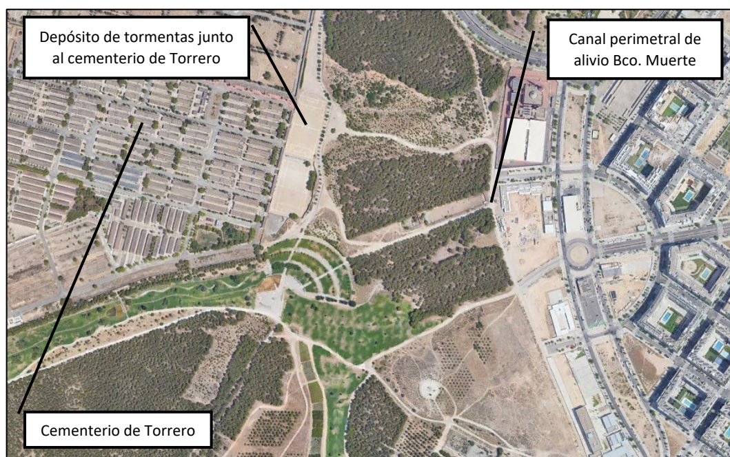
Ilustración 1. Emplazamiento del depósito de tormentas, canal perimetral de alivio del Barranco de la Muerte y cementerio de Torrero.
