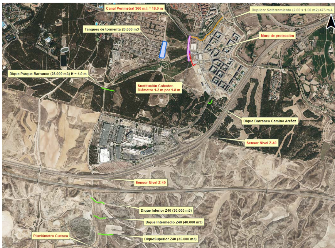
Planta General de Actuaciones. Textos en rojo. Fase 1. Textos en negro. Fase 2.
