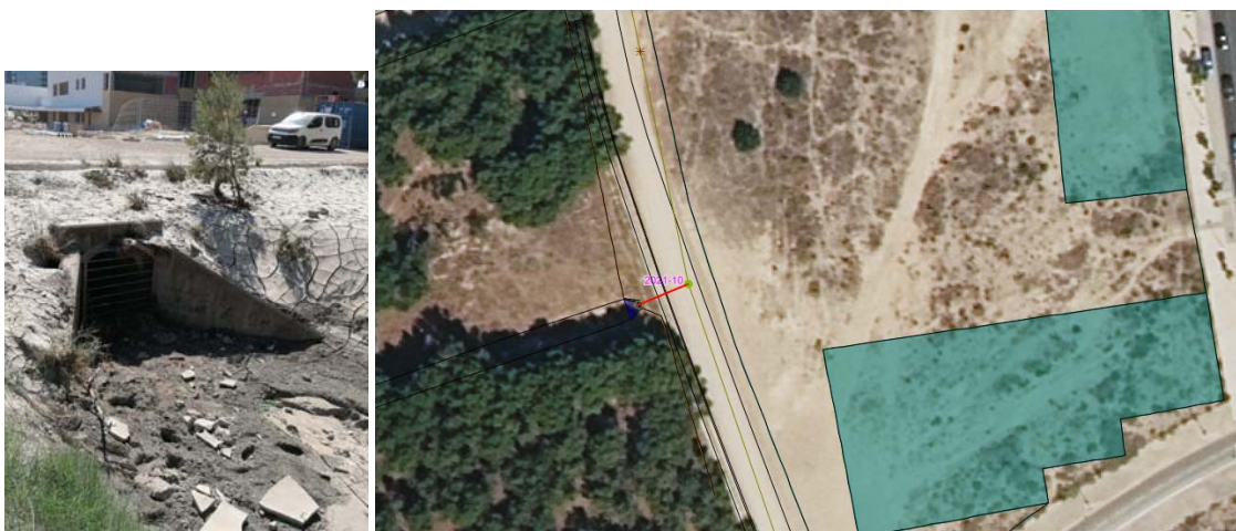
Colector a sustituir. Planta de actuación.
