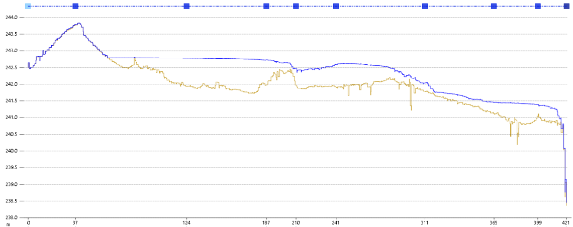
Perfil longitudinal de la cota de inundación para el diseño del muro de protección. Evento 6 de Julio de 2023
