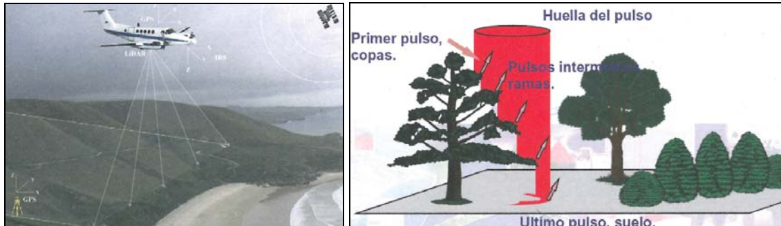
Toma de datos de LIDAR
