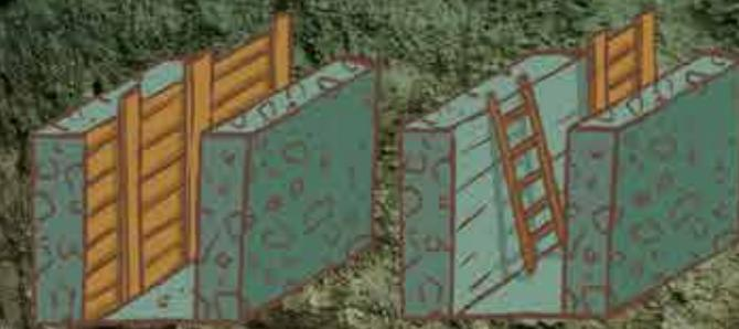
1 Encofrado de las paredes de hormigón, sujetas con tabloncillos de madera contra las paredes de tierra excavada.
