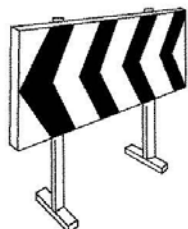
VALLA DE DESVIAMIENTO DE TRAFICO
