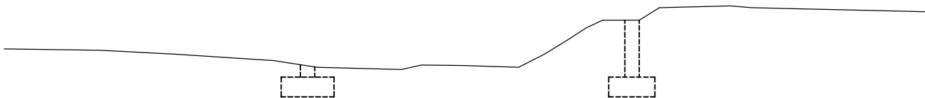
FASE 3.5 -Demolición mecánica de pilas y estribos y limpieza general
