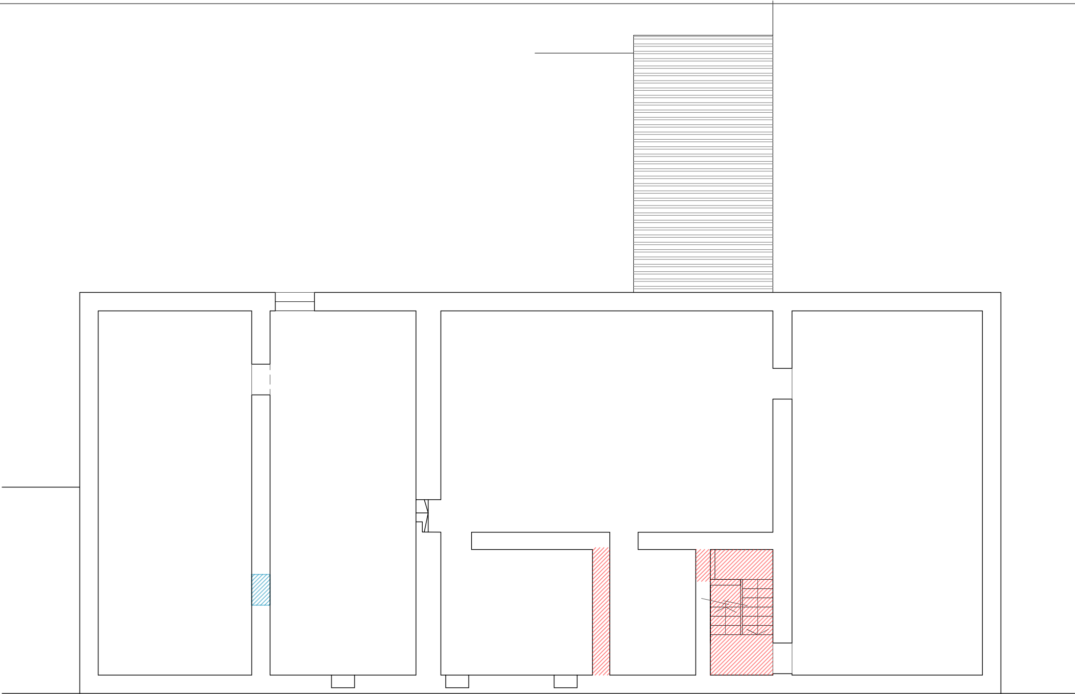
PLANTA PRIMERA (CON FORJADO DERRIBADO)
