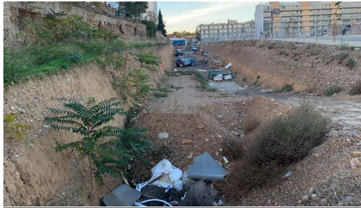
Figura 6. Trinchera excavada en la zona donde se aprecia la litología de la zona, formada por depósitos de gravas con matriz areno limosa, en la cual se intercalan paquetes de limos y arcillas
