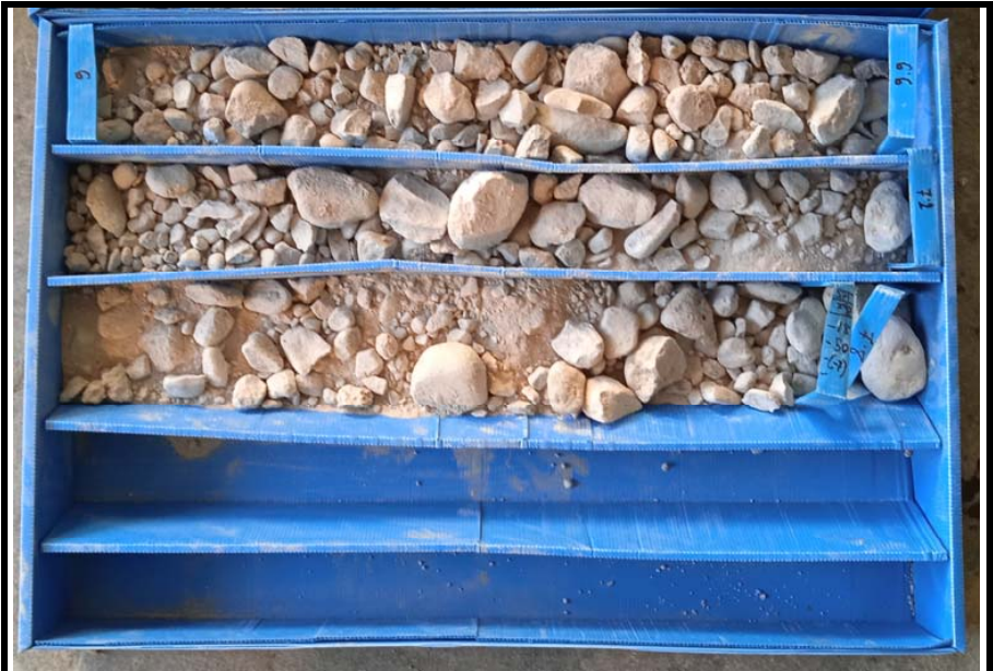
Sondeo S1. Caja 3. Profundidad: 6.00-7.80 m
