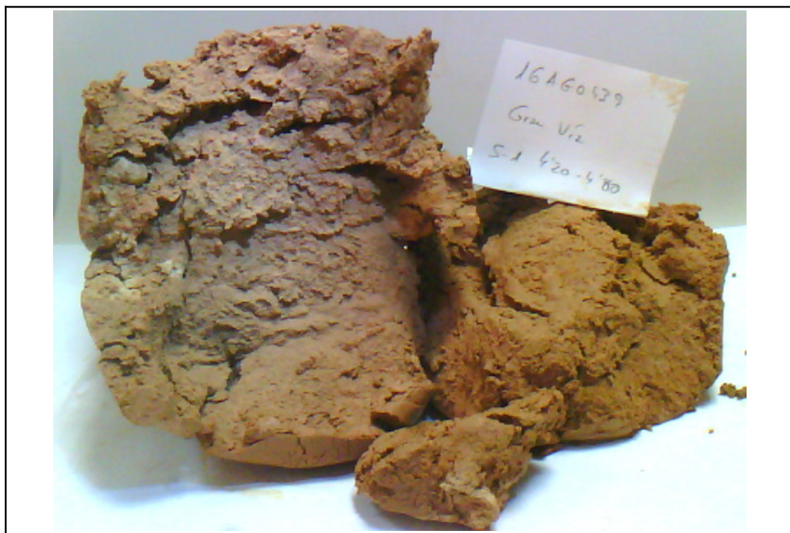
Detalle del plano de rotura
