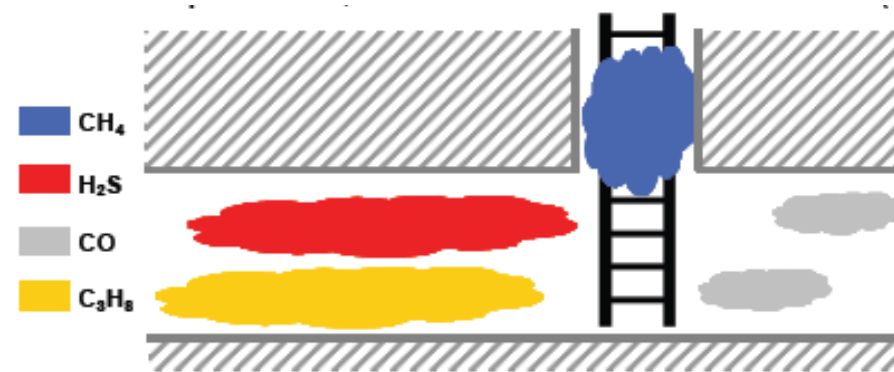
Ilustración 14. Distribución de gases en diferentes alturas en función de su densidad
