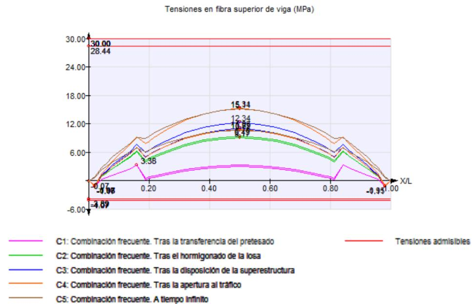
Ilustración 36. Cubrimiento del Huerva. Tensiones en fibra superior de viga. Intereje 1,0 m
