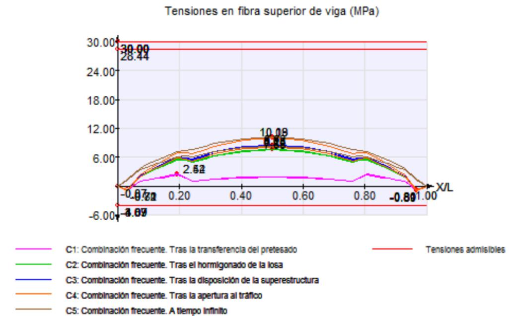
Ilustración 29. Cubrimiento del Huerva. Tensiones en fibra superior de viga. Intereje 1,5 m
