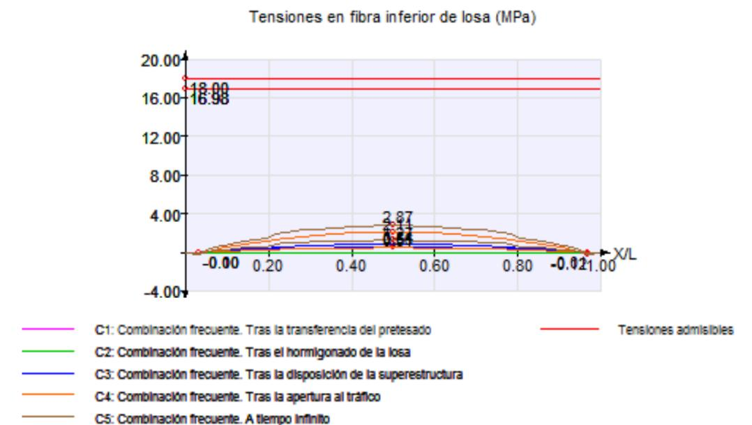
Ilustración 30. Cubrimiento del Huerva. Tensiones en fibra inferior de losa. Intereje 1,5 m
