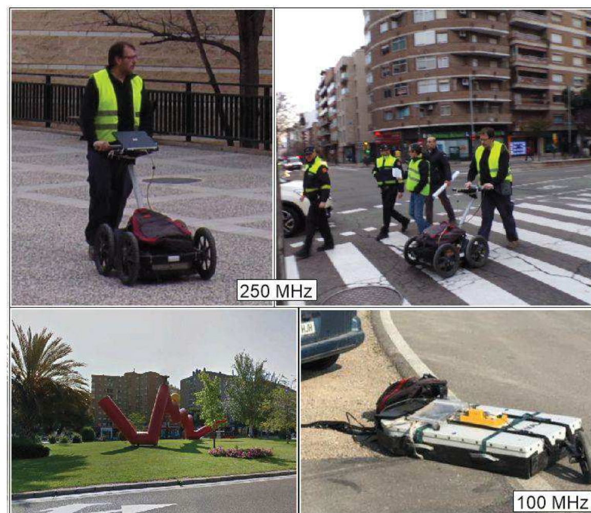
Figura 2.- Fotografía de las zonas de estudio y de los equipos utilizados durante la prospección.
