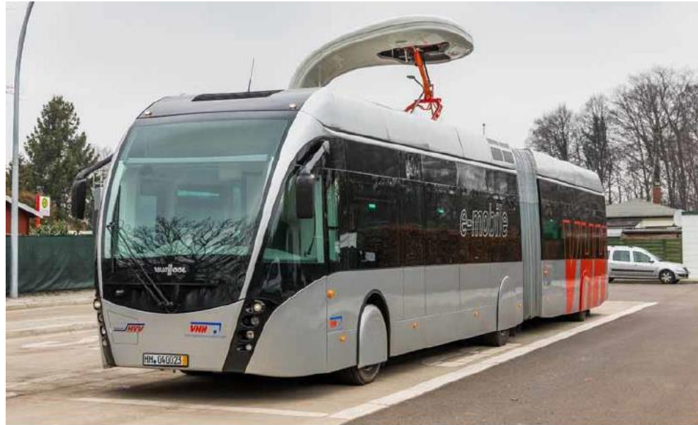
Ilustración 2. Autobús de carga rápida con pantógrafo invertido
