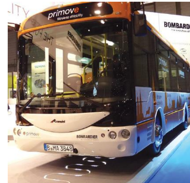
Ilustración 5. Autobús de carga rápida inductiva
