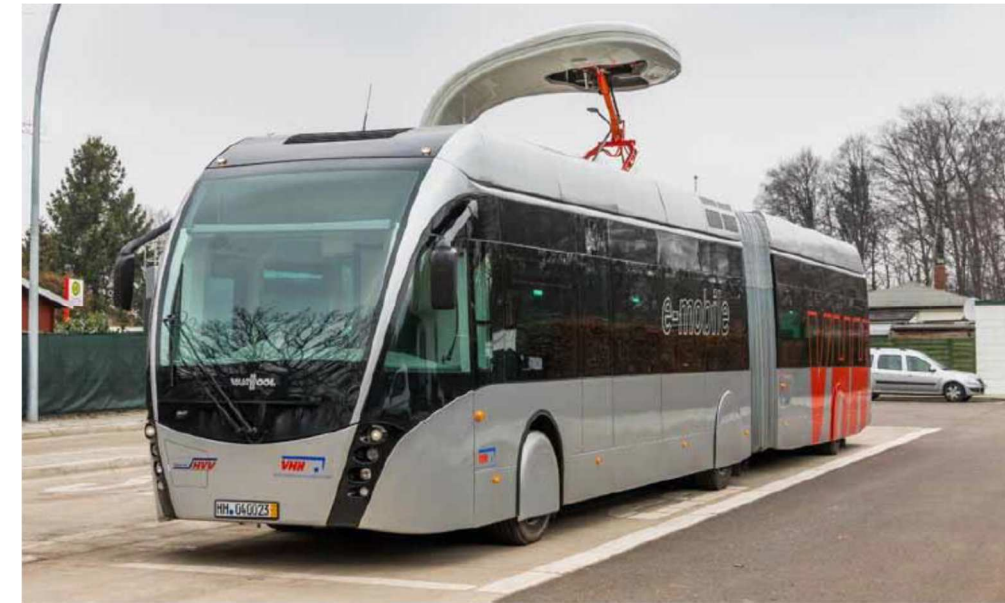
Ilustración 13: Autobús de carga rápida con pantógrafo invertido
