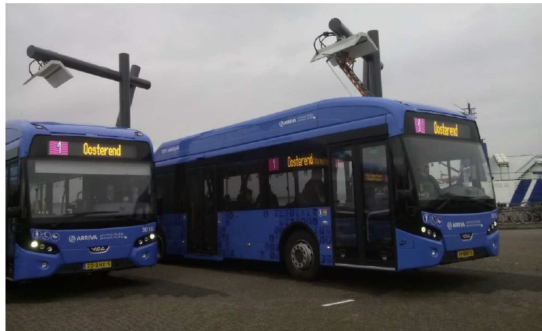
Ilustración 12: Autobús de carga rápida con pantógrafo en vehículo
