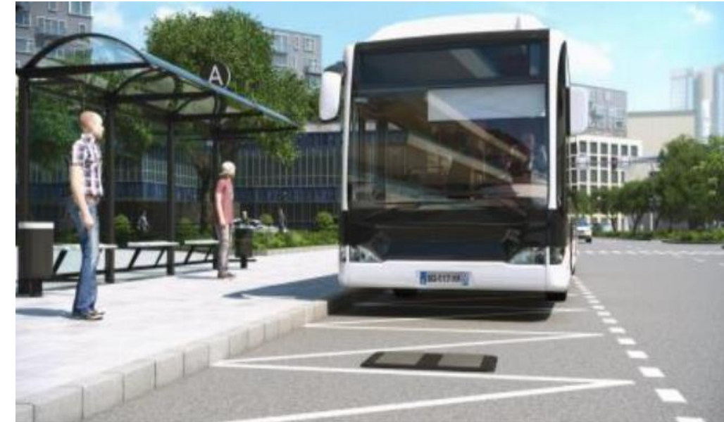
Ilustración 4. Autobús de carga rápida con contacto inferior
