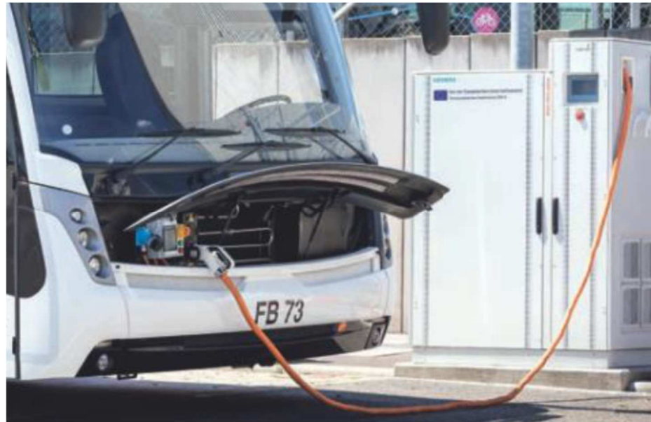
Ilustración 11: Autobús eléctrico con carga manual
