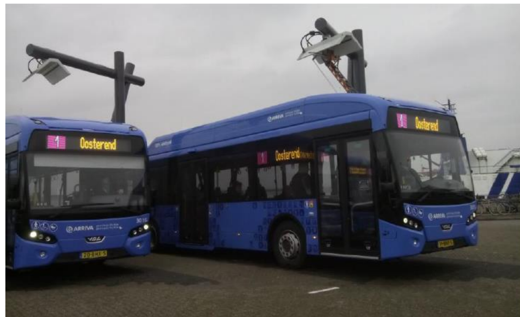
Ilustración 3. Autobús de carga rápida con pantógrafo en vehículo
