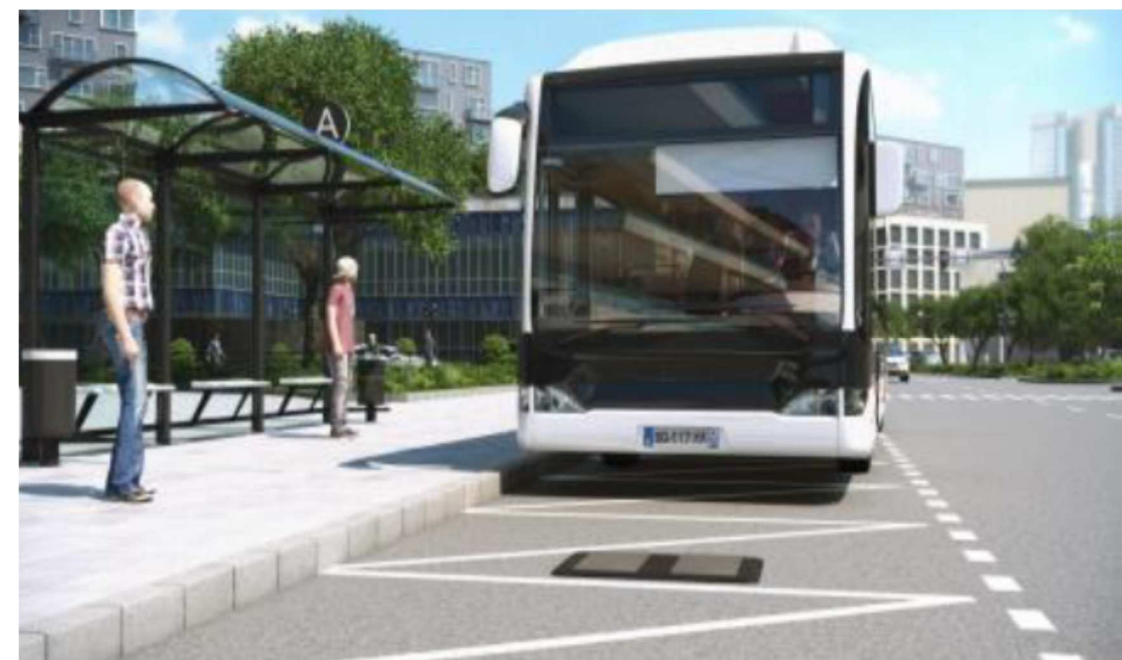
Ilustración 14: Autobús de carga rápida con contacto inferior
