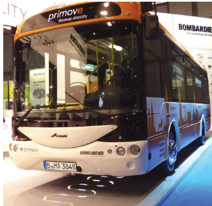
Ilustración 15: Autobús de carga rápida inductiva
