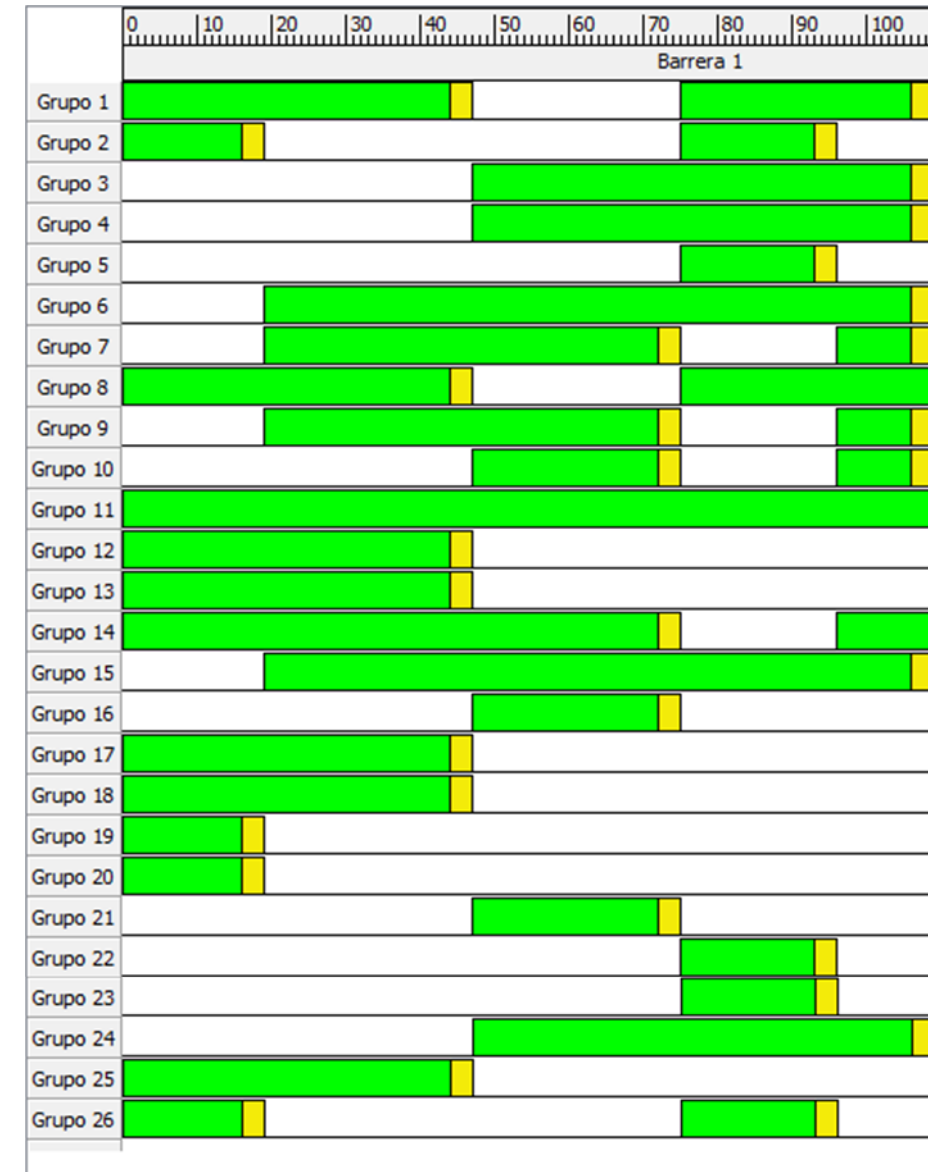
Ilustración 85. Glorieta Avenida Navarra con Calle Rioja. Plan semafórico futuro con paso tranviario
