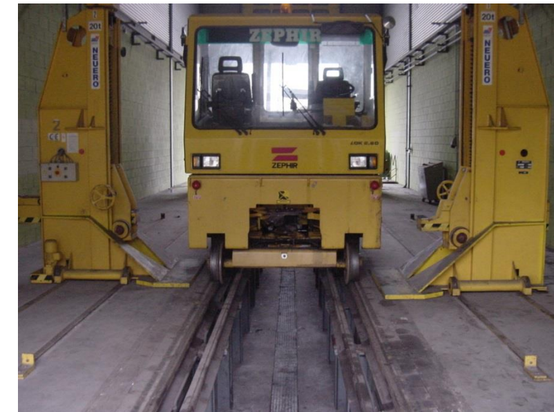
Ilustración 8. Sistema de elevación mediante gatos móviles
