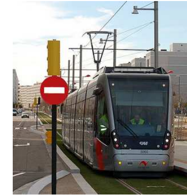
Captación por pantógrafo. Tranvía de Zaragoza
