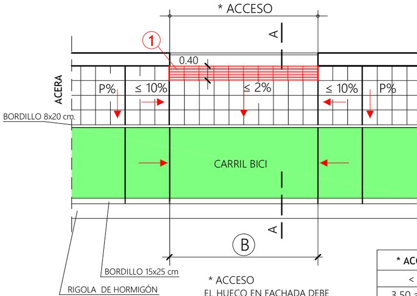
① BALDOSA TÁCTIL INDICADOR DIRECCIONAL DE BANDAS Y CONTRASTE CROMÁTICO (0.4 m) VER MODELO
