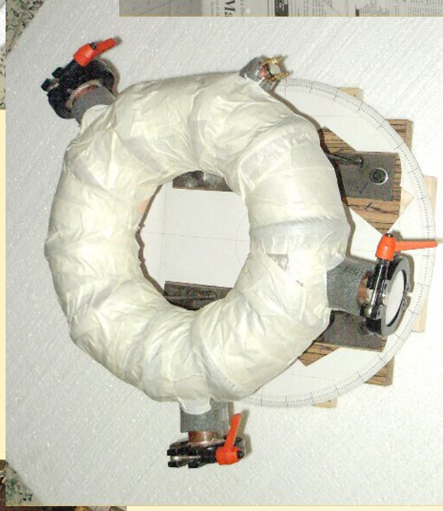
1 Mecanizando el molde de corcho blanco para la escayola. Semicírculo de alambre caliente girando sobre un eje
