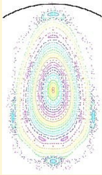
Octubre 2006 ↑ : Simulación de 300 quasi-partículas con drifts, partículas atrapadas y colisiones (sólo 10 en el gráfico) durante 150µs en 30 minutos-PC. 'guiding centre method' mejorado, FAST. (Arriba) 'helically trapped particle' en coordenadas Boozer-like. Máquina : UST_1 . Lenguaje : JAVA
