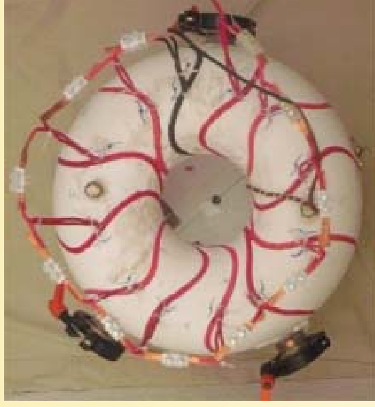
Las 12 bobinas modulares acabadas. (Antes de la instalación en el sistema)
