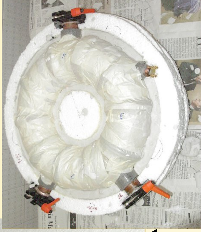
3 Cámara de vacío recubierta de capa flexible y hermética
