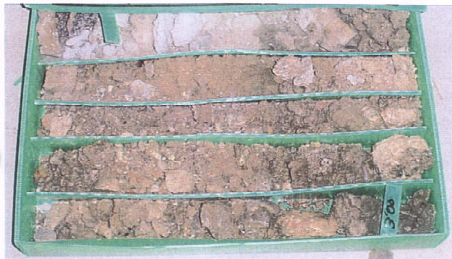
Sondeo Nº: S-20 Obra: U9 ECHEGARAY - EL PILAR Prof (metros): De 0,0 a 3,0
