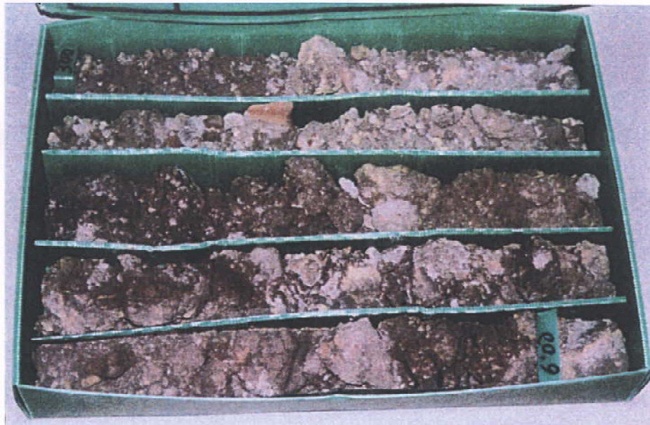
Sondeo Nº: S-18 Obra: U9 ECHEGARAY - EL PILAR Prof (metros): De 3,0 a 6,0
