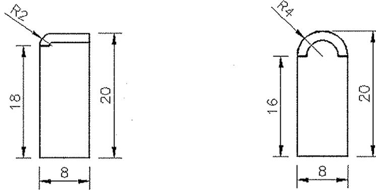
En todos los casos, los bordillos serán rectos o con la curvatura adaptada a su ubicación. La capa superficial (doble capa) será de espesor no inferior a uno con cincuenta centímetros (1,50 cm.).
